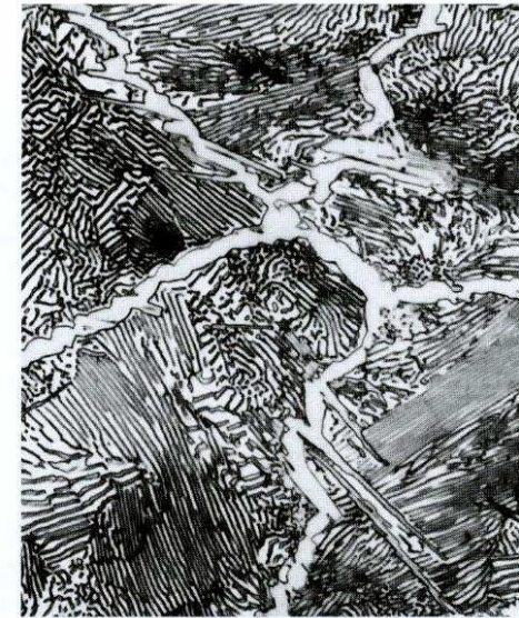
Fig. 3.52 Rappresentazione schematica delle strutture allo stato ricotto di acciai: a) eutettoide; b) ipo-eutettoide; c) ipereutettoide.
