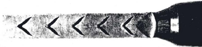
Figure 32 : Défauts internes (chevrons) sur barres d'acier filées à froid ( Central bursting defect )
