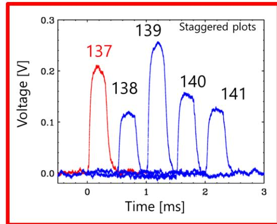
$^{137}\text{Cs} \sim 2 \times 10^7$  ions/pulse
