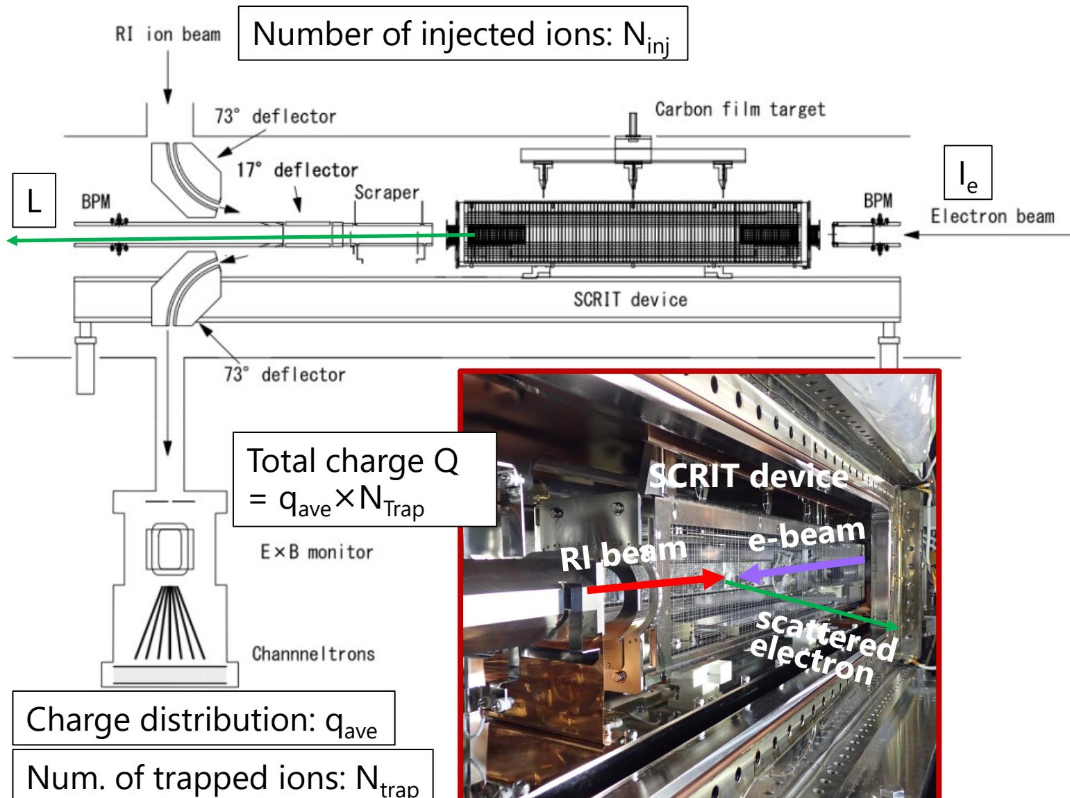
$$\text{Luminosity } L \sim \frac{I_e/e \cdot N_T}{\sigma} \text{ [cm}^{-2}\text{s}^{-1}\text{]}$$
