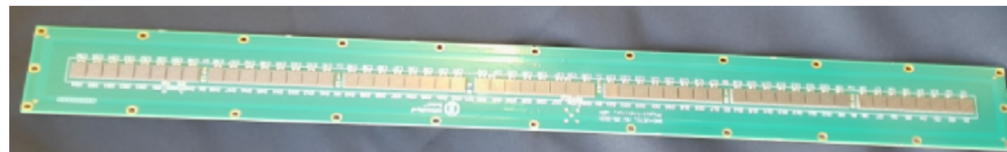
Veto PCB with 8 SiPM per bar
