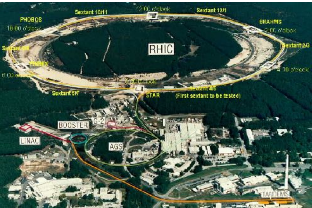
米国ブルックヘブン国立研究所(BNL) RHIC加速器(2000-) 全周3.8km \sqrt{s_{NN}}=10-200 GeV Au+Au
