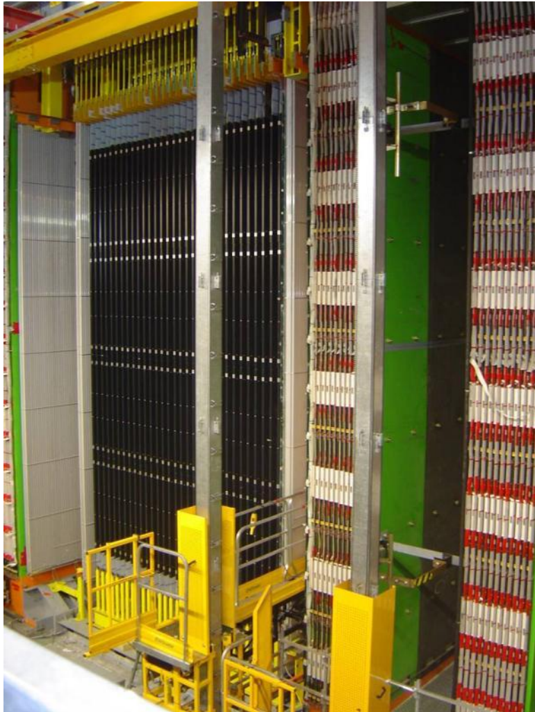
Scintillator planes 5900 m 2 8064 7m long drift tubes
