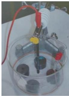
**!** Der Stromkreis sollte immer nur kurzfristig geschlossen und der Versuch bei offenem Fenster durchgeführt werden! Durch den Stromfluss im Salzwasser entsteht giftiges Chlor, das auch verantwortlich für die Schlierenbildung im Wasser ist!
