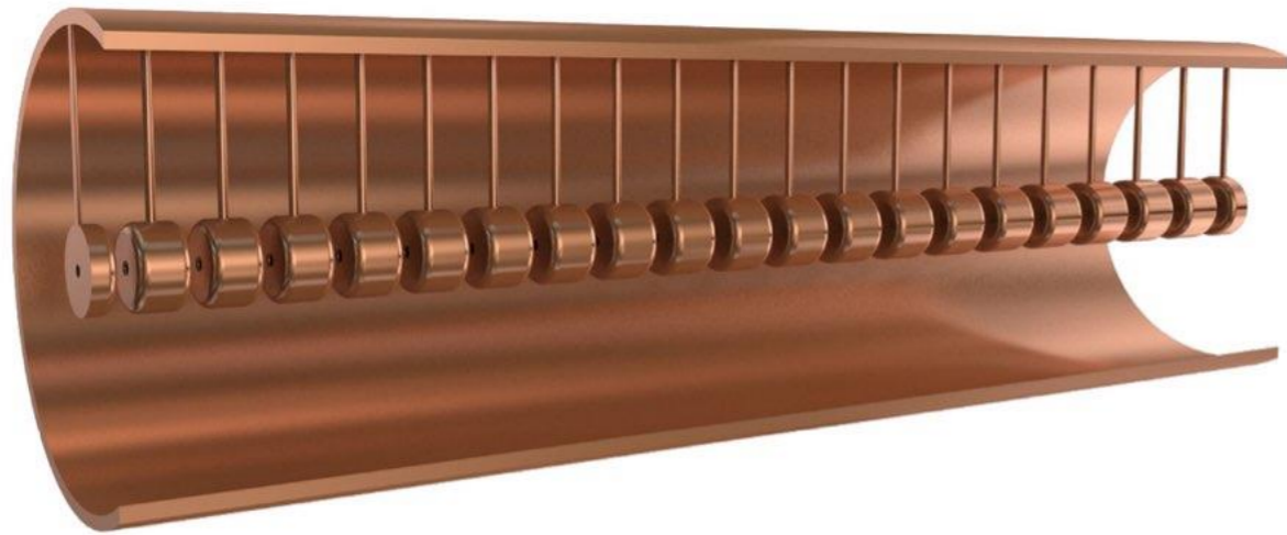
DTL: Drift Tube Linac
