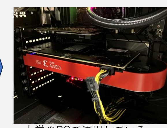
大学のPCで運用している Alveoアクセラレータカード
