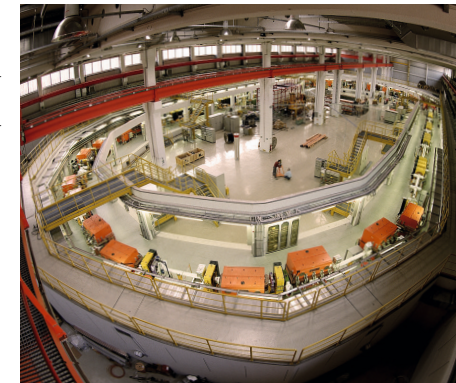
Das Synchrotron COSY am Forschungszentrum Jülich. Der Beschleuniger hat einen Umfang von etwa 180 Metern. Er erlaubt Protonen und Deuteronen (gebundener Zustand aus Proton und Neutron) zu beschleunigen. Die orangefarbenen Elemente sind Ablenkermagnete, um die Teilchen auf einer Kreisbahn zu halten.
