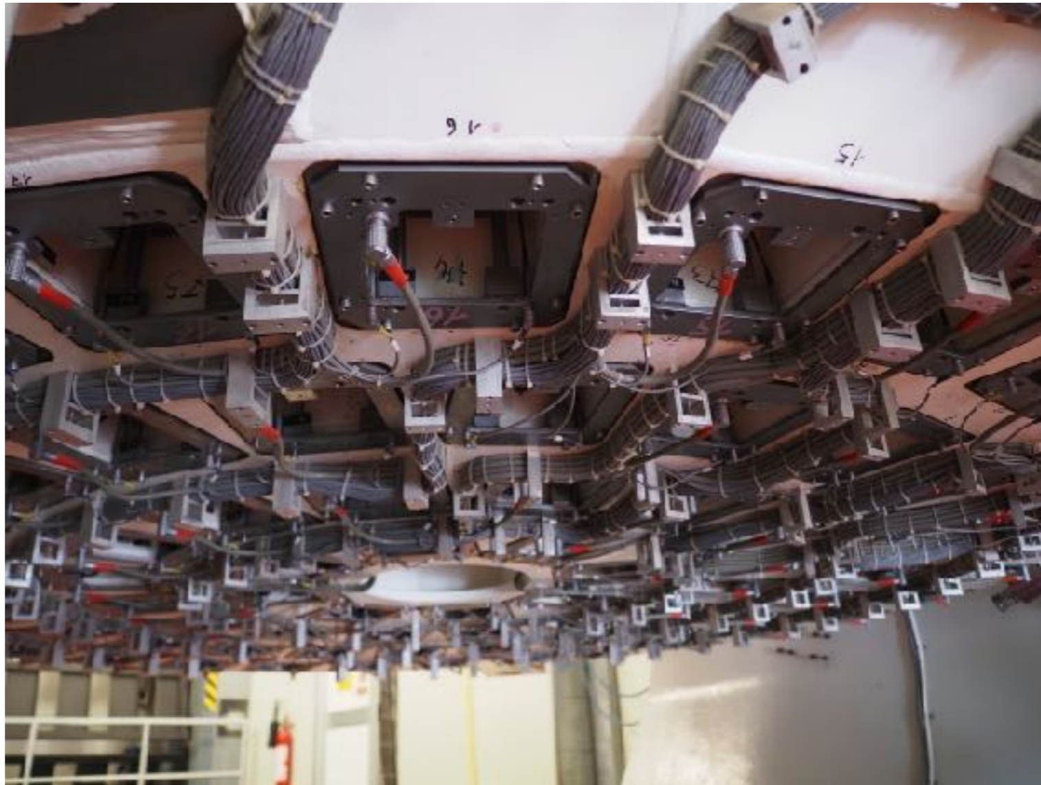
TNG: Lato inferiore dello specchio primario
