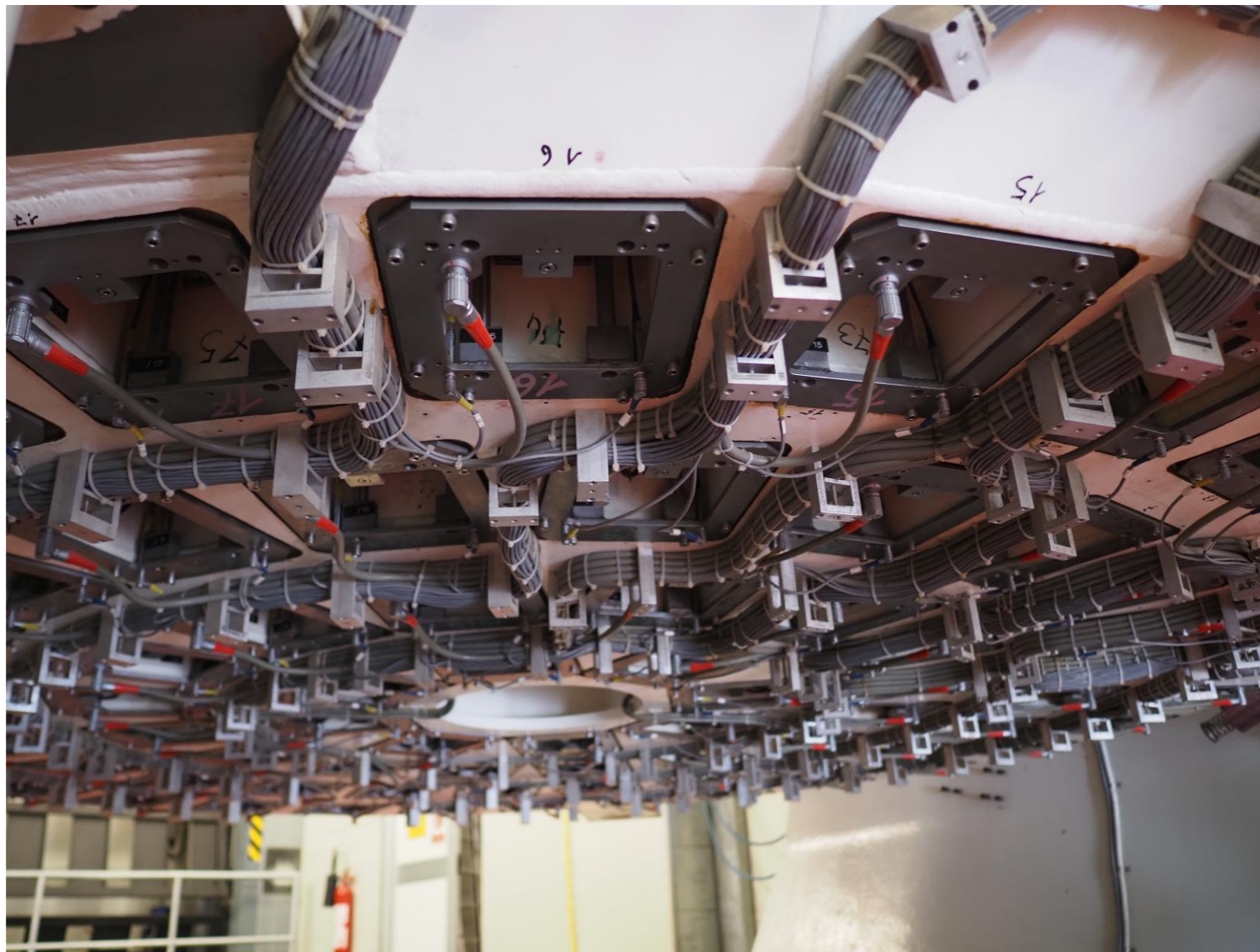
TNG: Lato inferiore dello specchio primario
