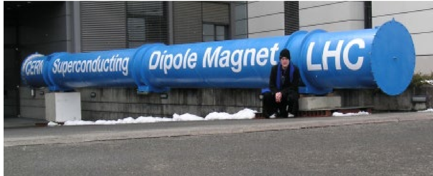
8.3 Tesla supermagnet – 15 m long
