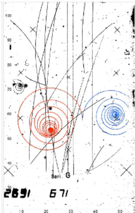
Dies ist eine Übung zur Blasenkammeraufnahme 2691, auf welcher zwei Spuren vom gleichen Vertex farblich hervorgehoben sind.
