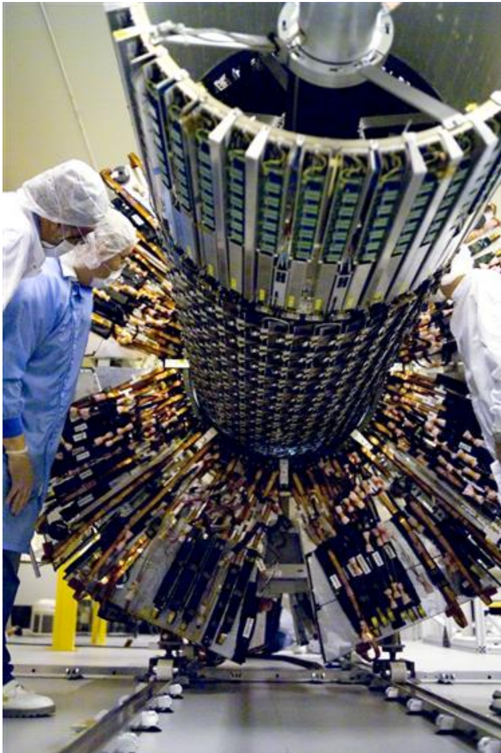
Внутрішній піксельний детектор, ATLAS, CERN
