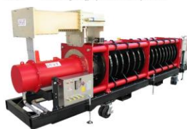
2012 – 3 MW cw 324 MHz Klystron, IHEP
