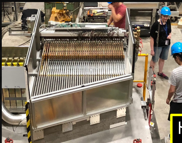
短冊型シンチレータと小型光センサ (SiPM)を組み合わせて粒子を検出
