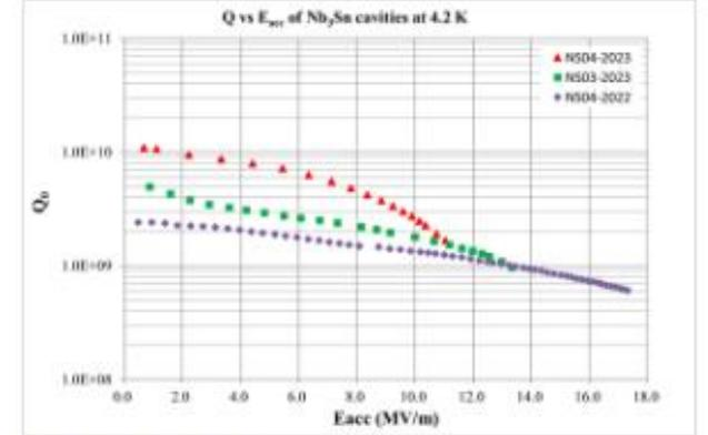
Coating: 1250°C, 120 min, Annealing: 1150 °C, 60 min
