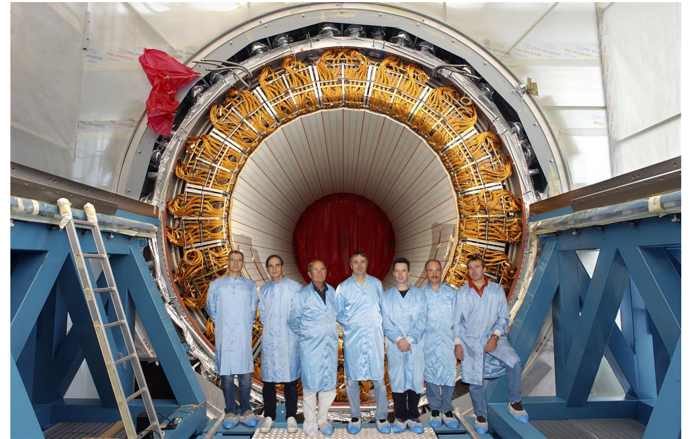
ATLAS LAr EM Calorimeter (ionization principle)
