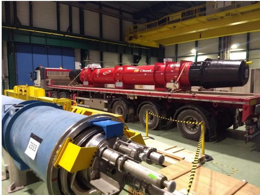
Il primo magnete in Nb<sub>3</sub>Sn di 7 m nel criostato rosso, e le bobine
