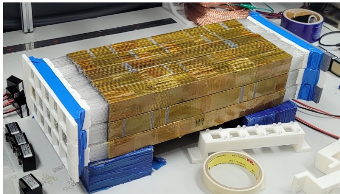
Pb/SciFi module 3x5 array
