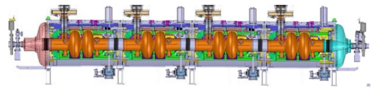
400 MHz cryomodule, ~12 m long
