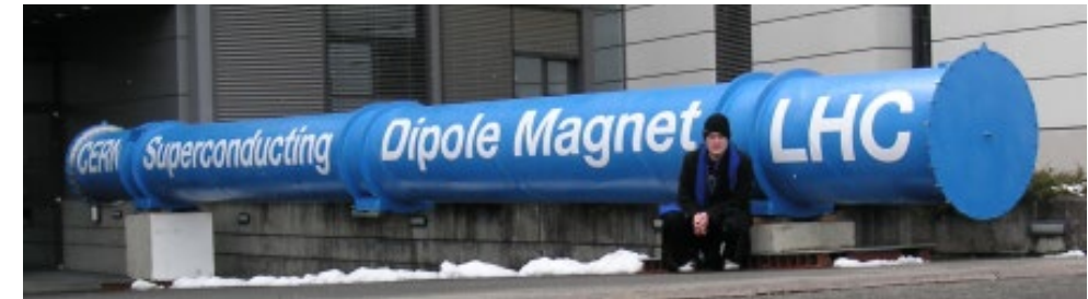
8.3 Tesla supermagnet – 15 m long
