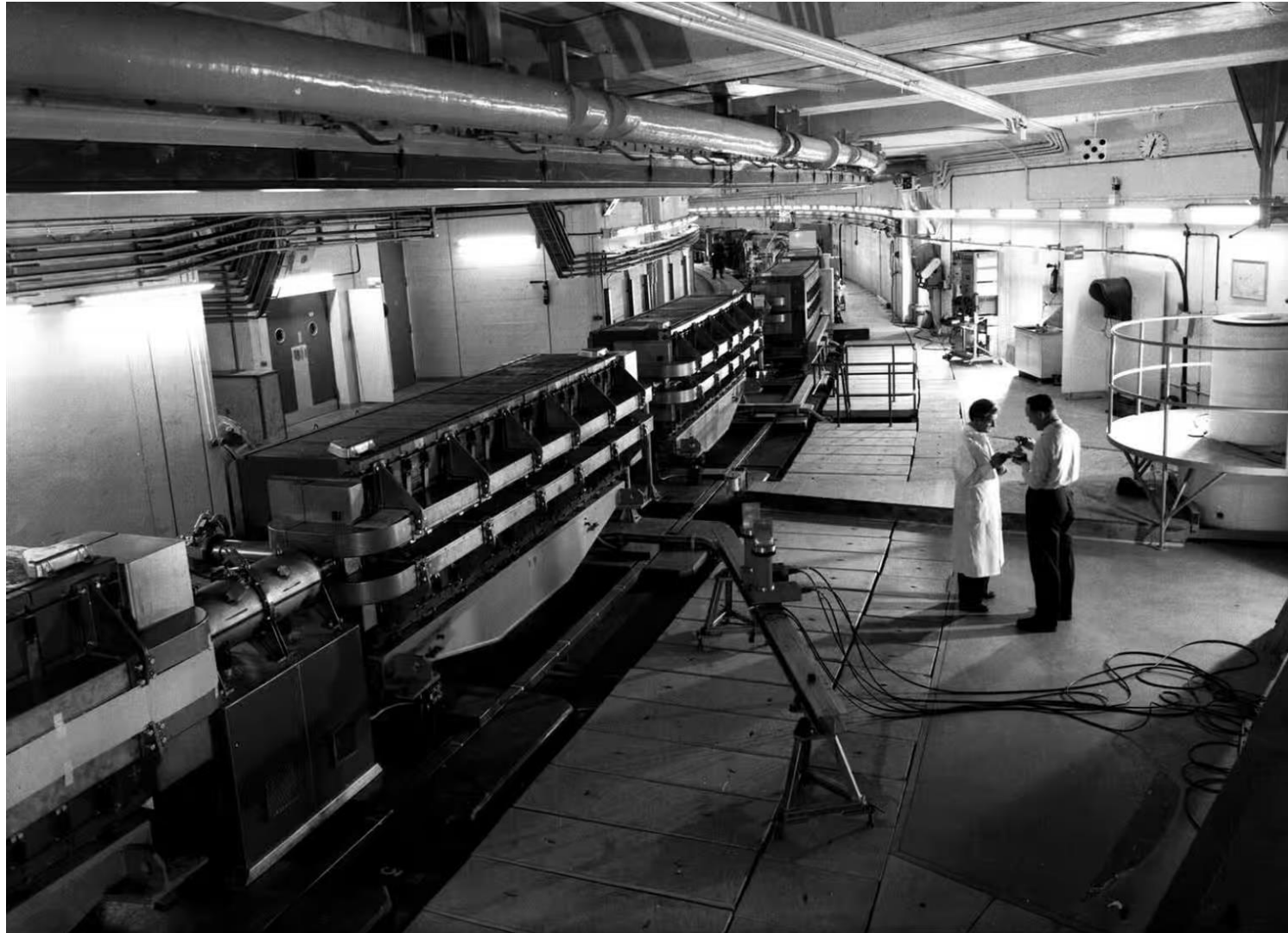
Proton Synchrotron 200 m de diamètre 25 GeV @ CERN
