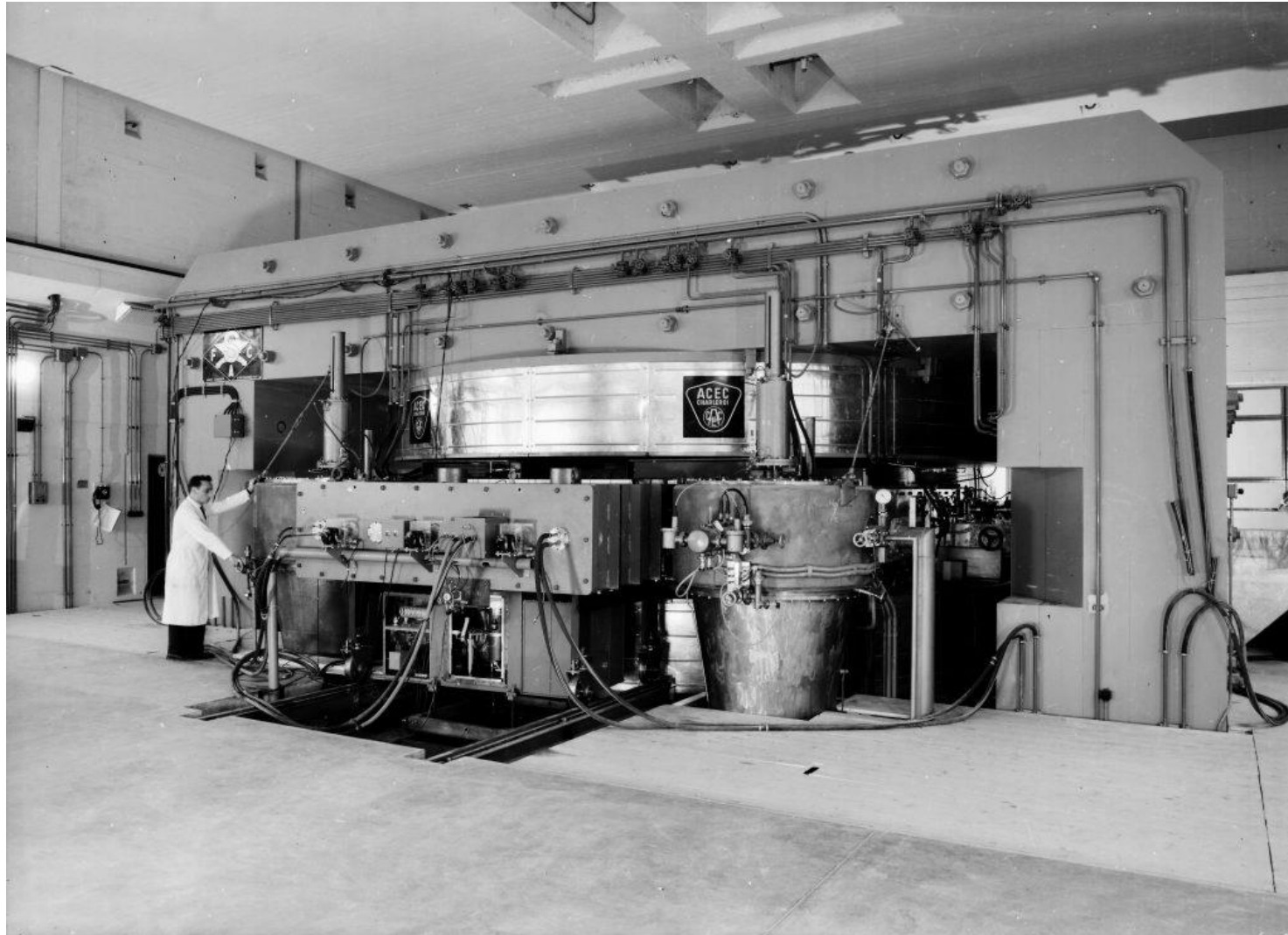
Synchrocyclotron 600 MeV 7,2 m de diamètre @CERN
