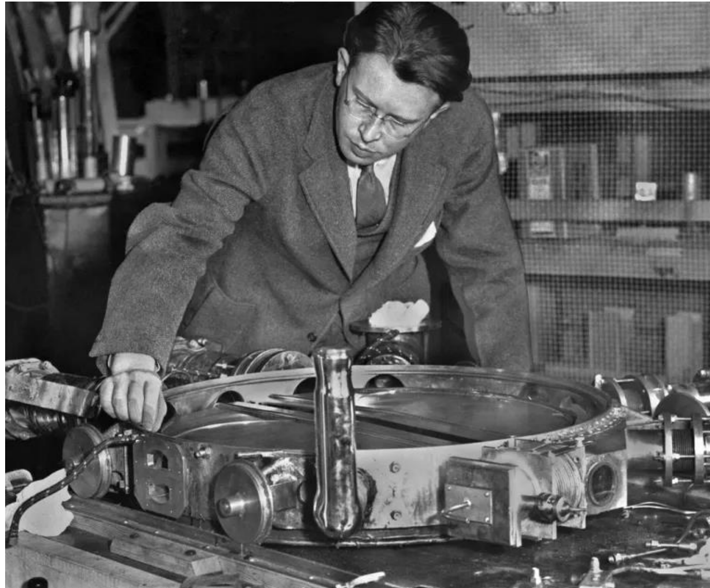
Cyclotron 0,94 m de diamètre 8 MeV Lawrence Berkeley National Laboratory
