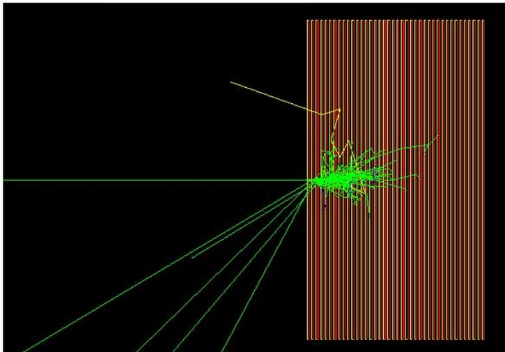
chuveiro eletromagnético devido a um fóton de 1 GeV ao incidir o calorímetro com 40 camadas
