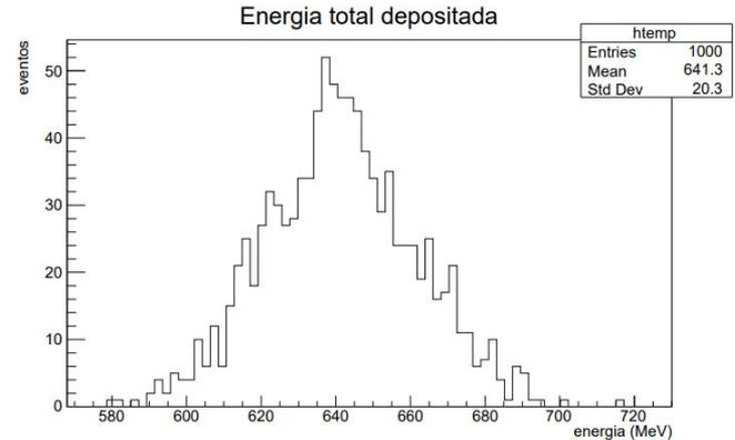
Espectro da energia total depositada em todas as camadas de silício devido a interação de 1000 fótons com energia de 50 GeV
