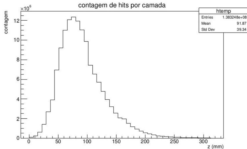
Perfil longitudinal devido a interação de 1000 fótons com energia de 50 GeV com o calorímetro de 40 camadas
