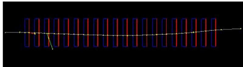
múon de 1 GeV atravessando as camadas do calorímetro
