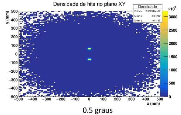
Densidades de hits na camada 9 do calorímetro devido 100 pares fótons com 50 GeV de energia cada, com angulação em relação ao feixe
