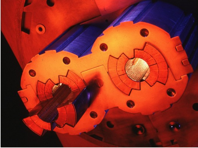
Magnesy dipolowe (żeby cząstki krążyły po okręgu)
