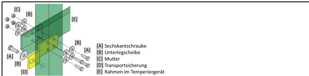
Entfernen Sie die Seitenverkleidung am Temperiergerät um die Transportsicherung lösen bzw. festziehen zu können.
