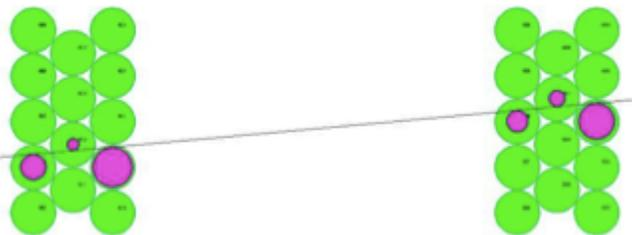
A medida do tempo de deriva (entre a passagem da partícula e a chegada dos electrões ao ânodo) é convertida num raio através duma correlação raio-tempo
