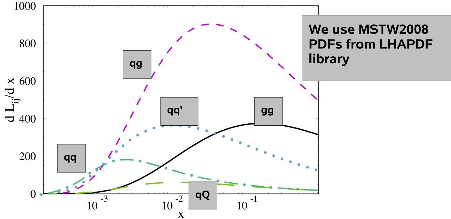
$$\sigma_{pp \rightarrow H+X} = \sum_{ij=g,g,\dots} \int_{m_H^2/S_{part}}^1 dx \left[ \frac{d L_{ij}}{dx} \right](x) \sigma_{ij \rightarrow H+X}(x)$$
