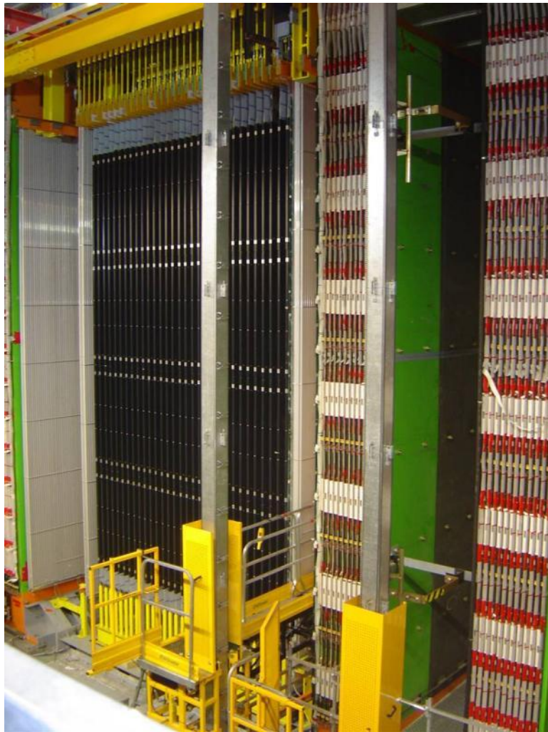
Scintillator planes 5900 m 2 8064 7m long drift tubes
