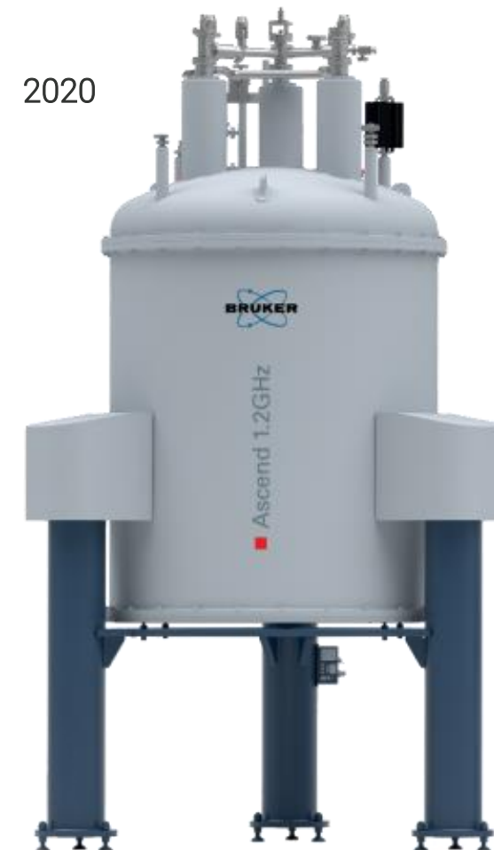
Ascend 1.2 GHz: HTS/LTS hybrid, 2 K (28.2 T)
