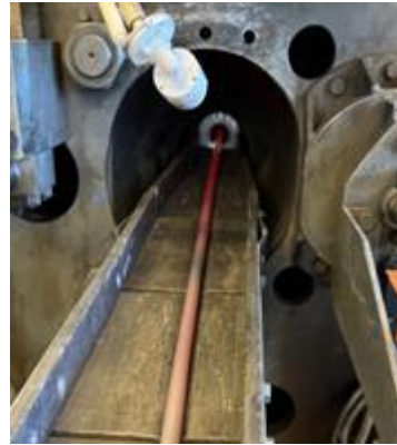
Hot Extrusion (500°C – 600°C)
