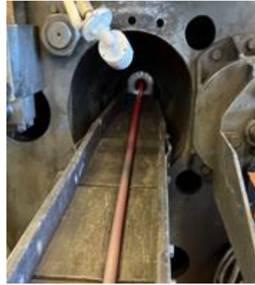
Hot Extrusion (500°C – 600°C)
