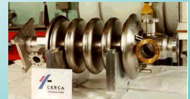
Cavité APT (Los Alamos) 700 MHz - \beta = 0,64
