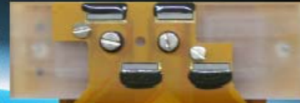
IRST SiPM-Array auf Hybrid ge- bondet
