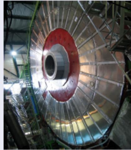
Cámaras de placas resistivas (RPC) en el Barril y las tapas. Disparador del "*trigger*" debido a su alta velocidad de respuesta.
