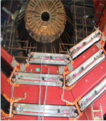
Cámaras de tubos de deriva (DT) en el barril. Disparan la adquisición del suceso ("*trigger*") y miden con precisión la posición de paso del muon.
