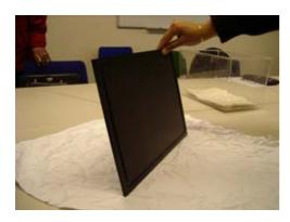
Si no ha conseguido una placa metálica negra deberá cubrir completamente la chapa o placa metálica con cinta aislante negra. Esto hará que después le resulte mucho más fácil ver las "trazas blancas de partículas" sobre un fondo oscuro. El fondo estará en contacto con el alcohol cuando la cámara esté en funcionamiento, así que procure que ni la cinta ni su adhesivo sean solubles en alcohol. Si ya tiene una placa metálica negra, pase al punto 2.
