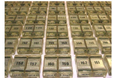
192 detector modules (2 APD cada módulo)
