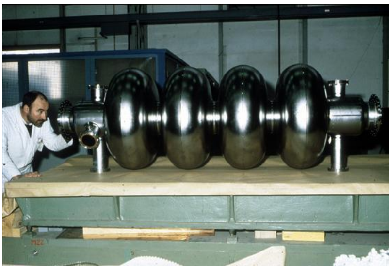
БАК, сверхпроводящие, 400МГц Ускорение 5 МВ/м
