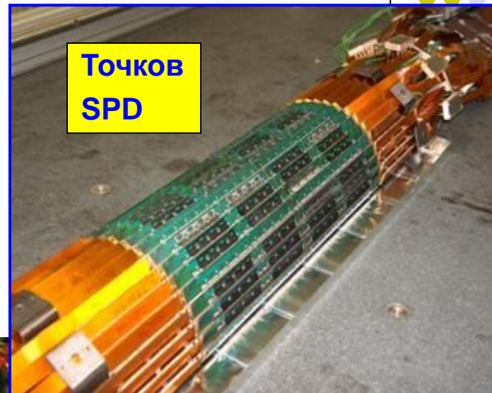
Вътрешен тракер ~ 10 m 2 Si , 6 слоя: пикселен, дрейфов, двустранен лентов
