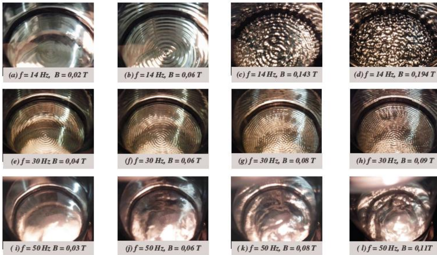
Figure 3.17 : Forme dynamique de l'interface mercure-électrolyte. Vue par-dessus pour différentes valeurs de fréquence et d'intensité de champ magnétique.
