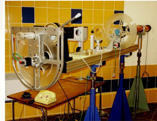
Rys.3 Oprzyrządowana lawa optyczna zainstalowana w pomieszczeniu radioterapii protonowej w IFJ PAN Kraków. Widoczne są elementy układu formowania i monitorowania wiązki protonowej, układu podglądu położenia oka, układu pozycjonowania oka oraz układu do pomiaru rozkładu dawki w obszarze pików Bragga.
