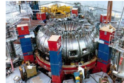
Tore Supra, Cadarache (1988 – 2003; 6 min Plasma) 1.8 K service (316LN)
