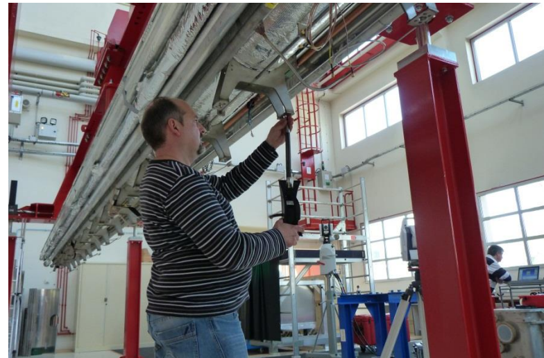
Alignement des cavités par LaserTacker
