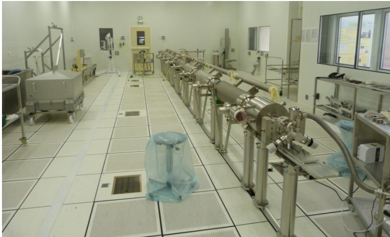
Montage du train de cavités en ISO4
