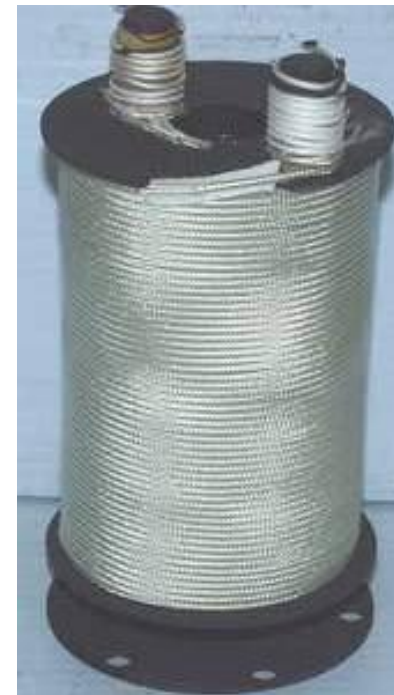
14 layer coil: 70 od x 25 id x 100 (mm) long
