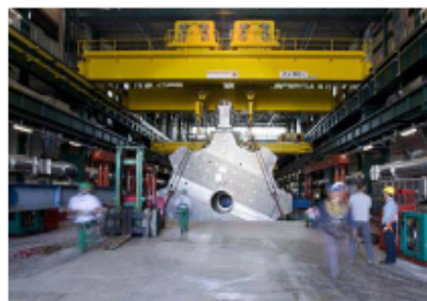
La descente de l'un des toroïdes d'extrémités
