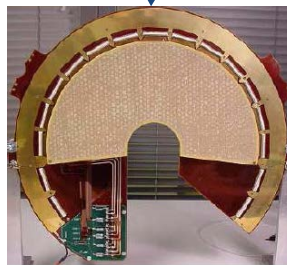
T2: triple GEM detector
