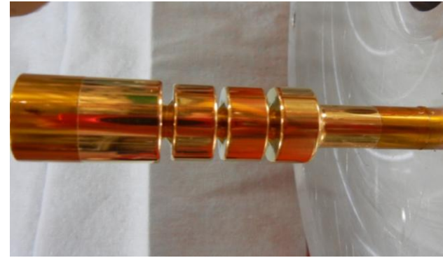
3 \mu\text{m} thick Au coating
