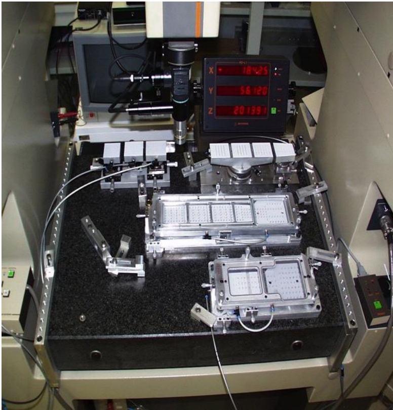
Si module assembly production
