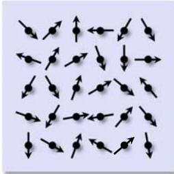
Bei einem **Ferromagneten** sind am Anfang, bei hoher Temperatur, keine ausgezeichneten Richtungen ausgezeichnet.
