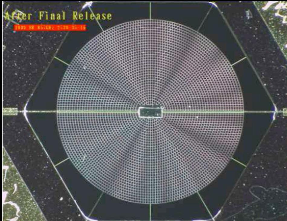
Bolomètre avec thermomètre au centre et grille en forme de toile d'araignée.
